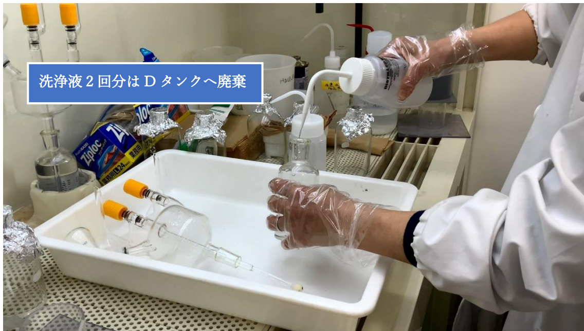
③サンプル瓶の内側を2回すすいで廃液はDタンクへ廃棄する
