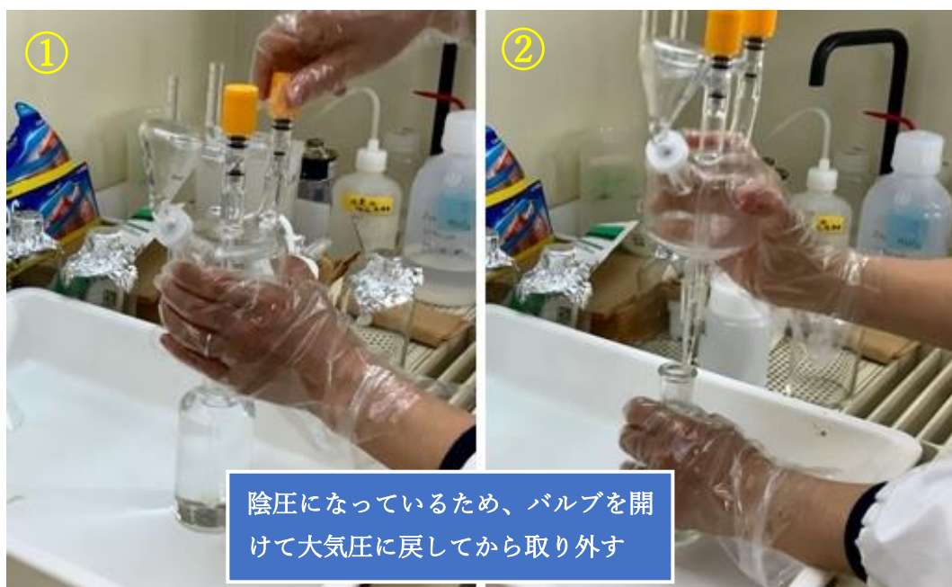
①バブリング装置をサンプル瓶から外す
