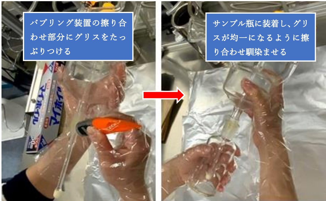
④バブリング装置の擦り合わせ部分にグリスを塗り、サンプル瓶に取り付ける。
