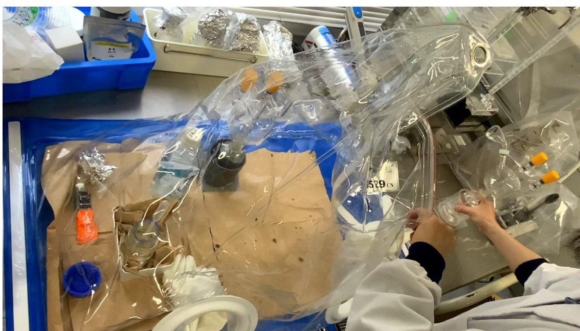
⑨グローブボックスを開け、バブリング装置を取り出す。精製準備完了！
