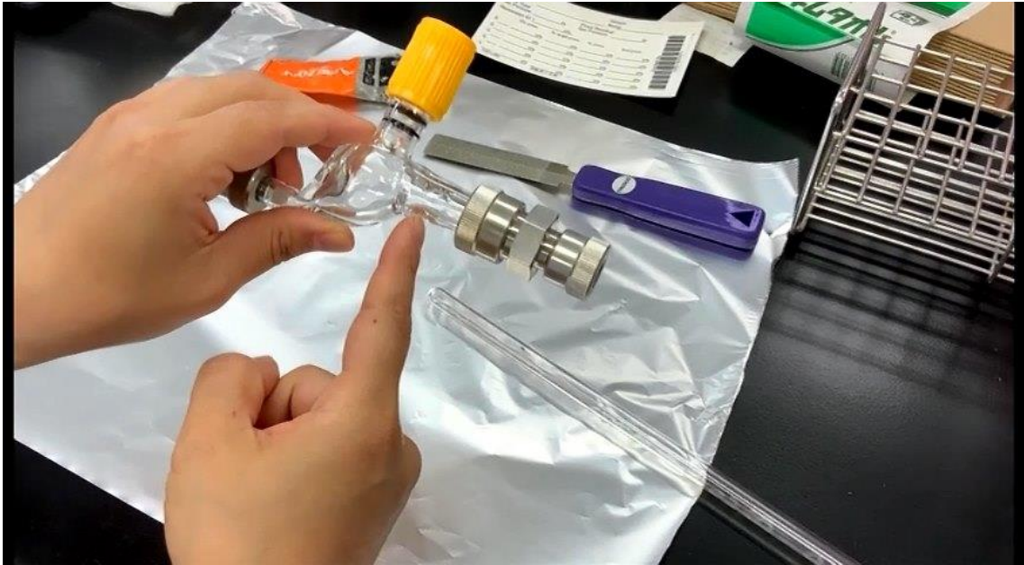
③石英管を割る位置（くびれ）を確認する。
