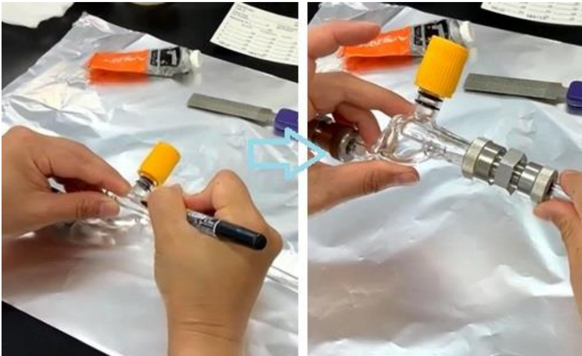
④ブレーカーの上から石英管を合わせ、くびれ位置にマジックで印をつける。 実際にブレーカー内に石英管を挿入し奥まで入れ、そこから 1 mmほど戻した位置を確認する。
