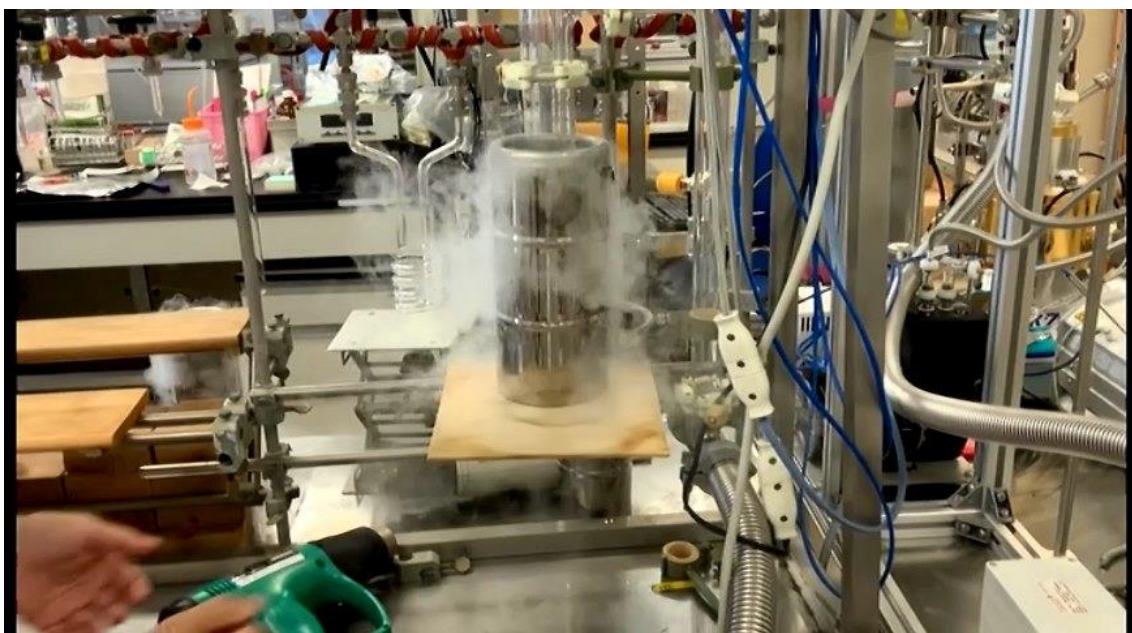
③真空ポンプ直近のトラップをLN2で冷やす。
