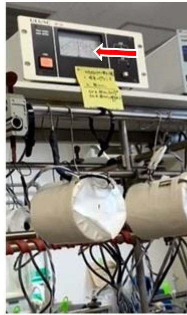
⑤VA3 をゆっくり開き、圧力計の針がスーッと下がるのを確認する。
