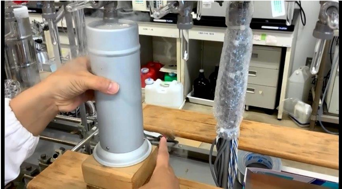
⑪LN2 をなみなみ注いだデュアーを一つの port に設置する。
