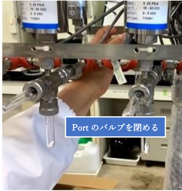
⑮モニターで各 port の CO2 値が安定していることを確認し、port のバルブを閉じる。
