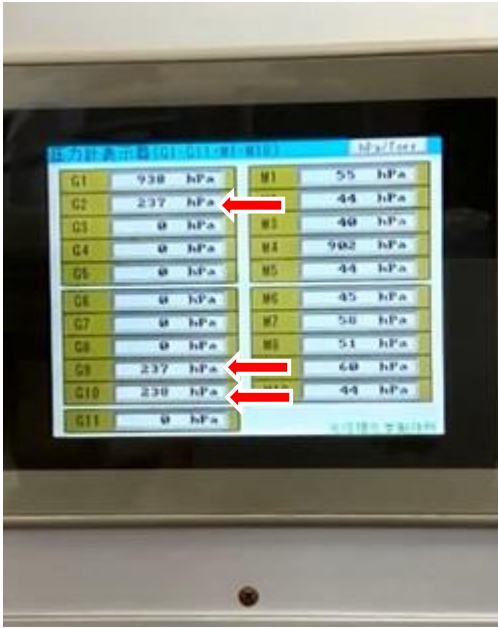
⑮モニターで各 port の CO2 値が安定していることを確認し、port のバルブを閉じる。
