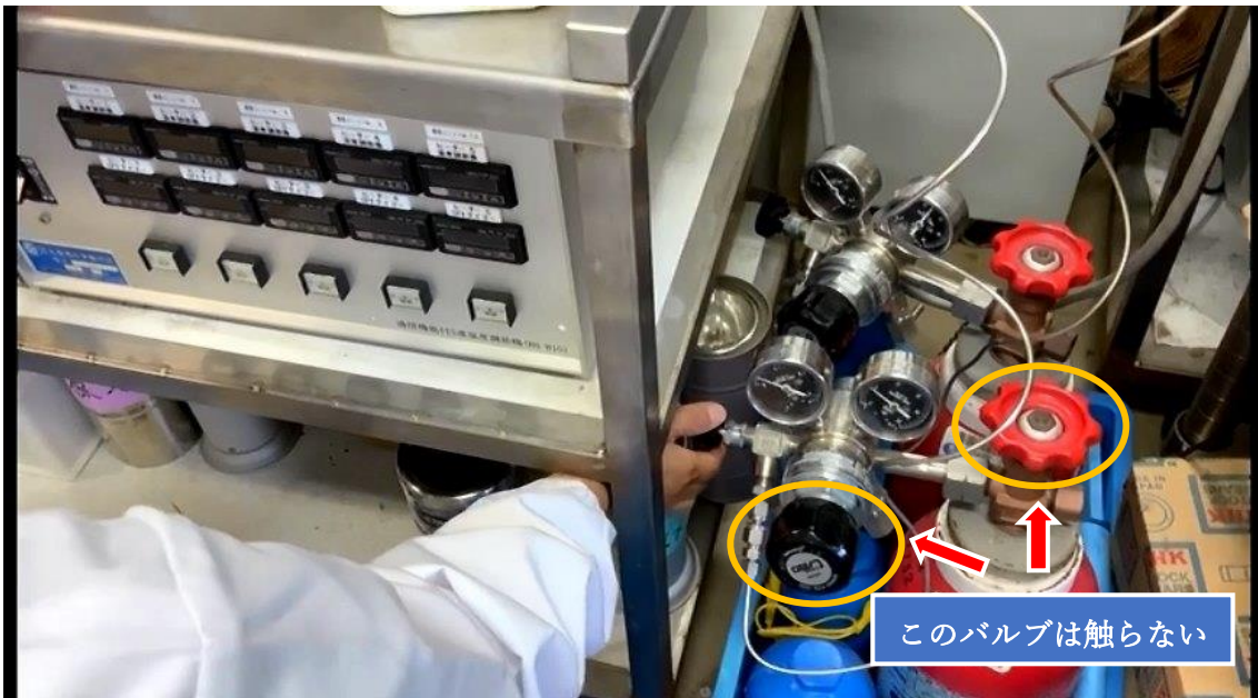
⑥モニターを見ながら H2 target press 値の H2 を各 port へ入れていく。
