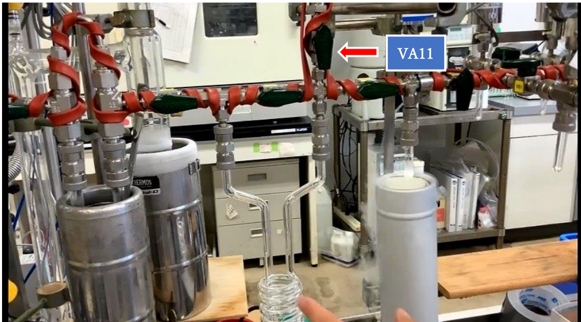
⑧VA11 を開き、不要なガスを真空引きする。 真空計の値が \leq 5.0 \times 10^{-3} となるまで真空引き
