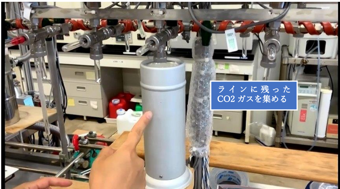
⑮モニターで各 port の CO2 値が安定していることを確認し、port のバルブを閉じる。
