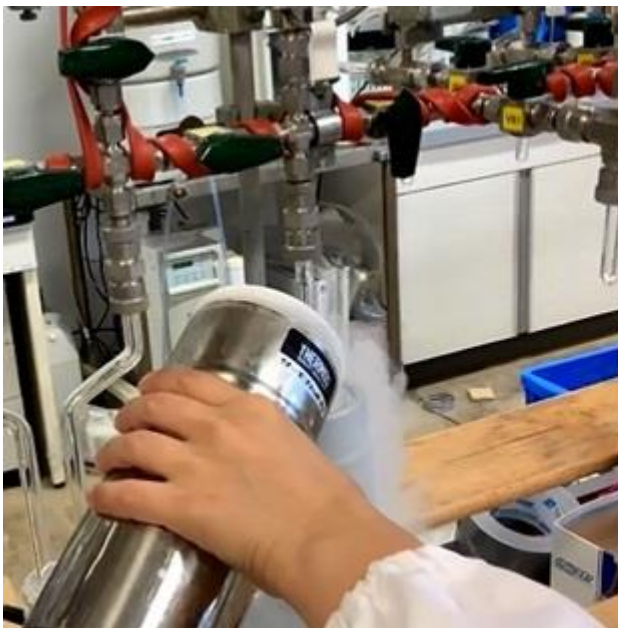
⑥圧力計の針の動きが落ち着いてきたら、LN2 をデュアーに注ぎメスアップする。圧力計の針の動きが止まったら Residual Gas Pressure に値を記入する。
