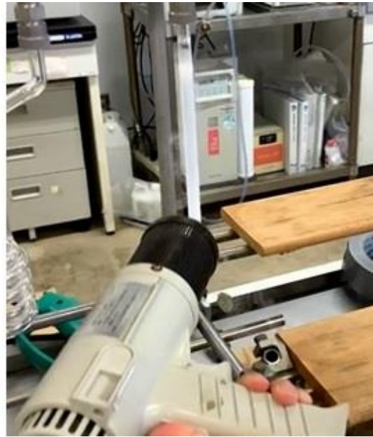
⑨VA5 を閉じる。CO2 トラップの LN2 デュアーを取り外し、CO2 トラップを温める。
