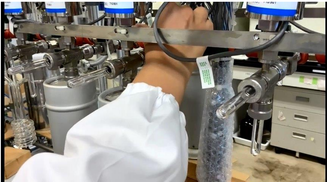
⑦H2 target press 値に達したものから port バルブを閉じる。H2 press に実際の H2 量を記入する。
