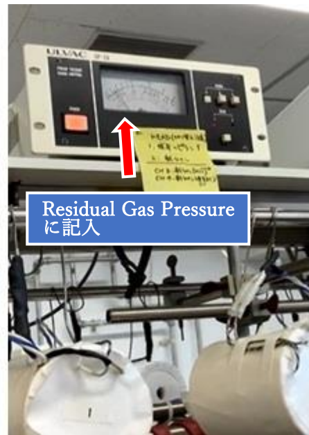
⑥圧力計の針の動きが落ち着いてきたら、LN2 をデュアーに注ぎメスアップする。圧力計の針の動きが止まったら Residual Gas Pressure に値を記入する。
